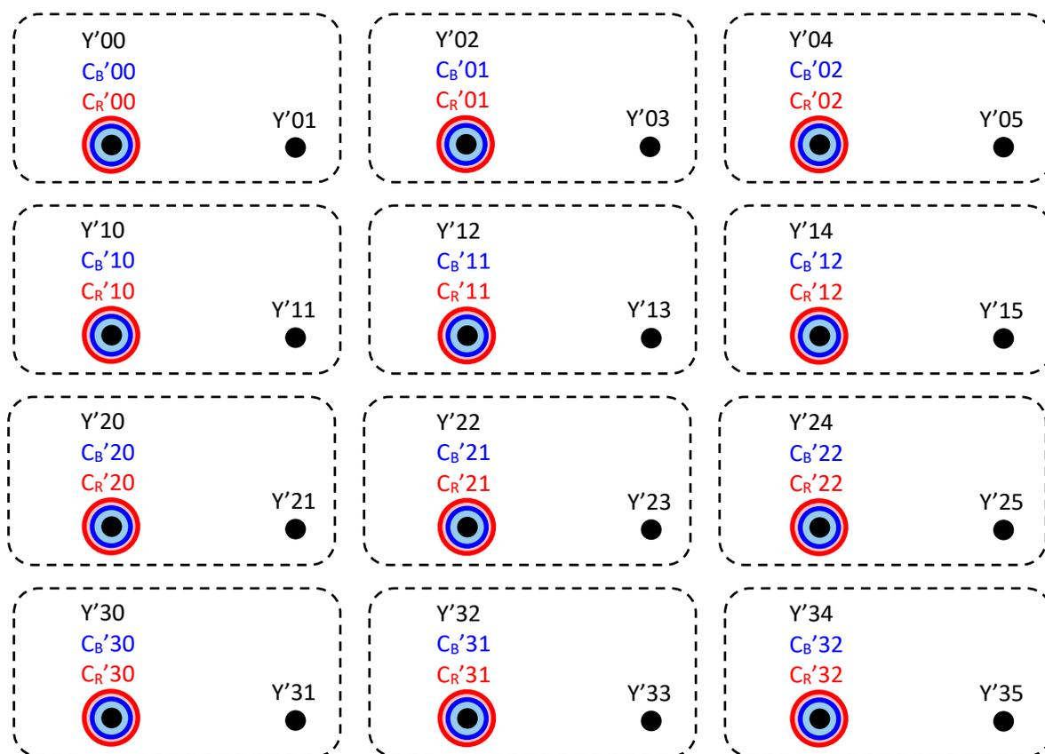
注：图中，Y和C分量的下标索引反映了采样在其采样数组中的位置，Y和C采样数组由于子采样而具有不同的维度，例如采样 $C_B'12$ 和采样 $Y'14$ 相对应。
